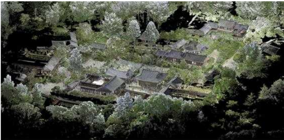
<세계유산 순천 선암사(사적 제507호): 멸실·훼손에 대비, 3차원 지상 라이다로 200억개 위치 데이터를 취득, 3mm 이하 점밀도의 디지털 원형기록 구축(* 20년, 문화재청)>
